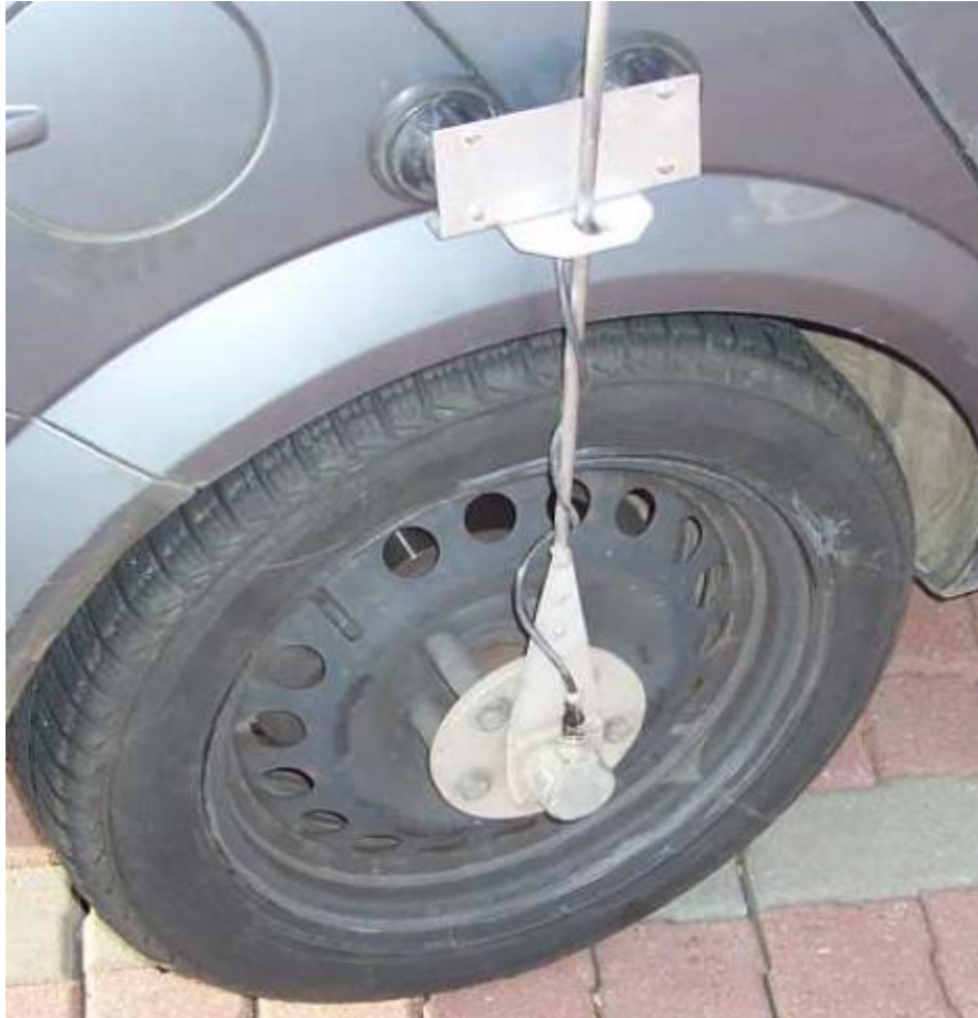
Ukážka umiestnenia odometra na vozidle
